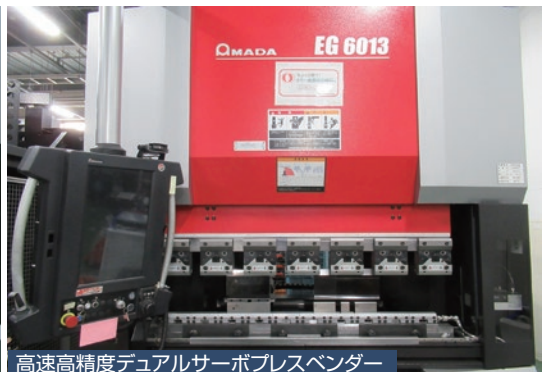
高速高精度デュアルサーボプレスベンダー
