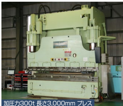
加圧力300t 長さ3,000mm プレス
